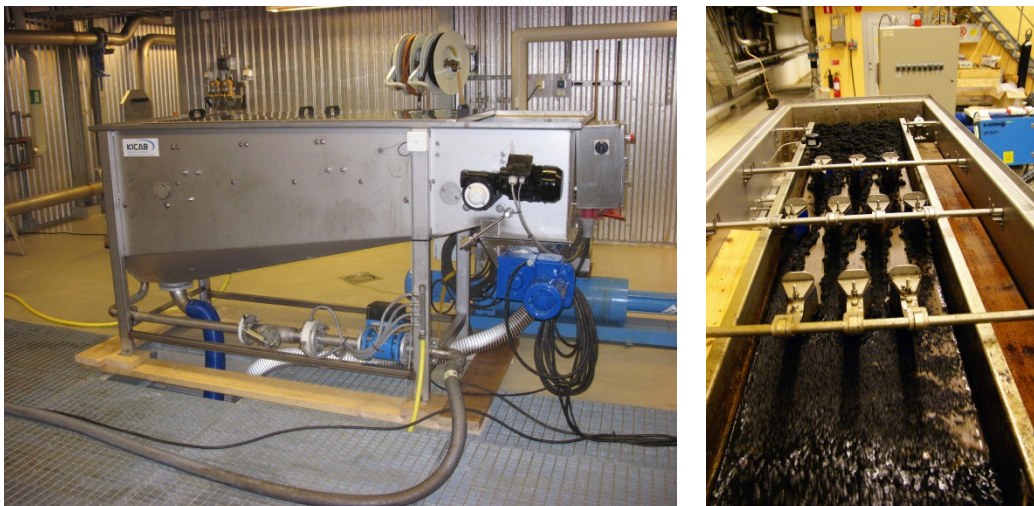
Figur 6. Kicab K-500 bandförtjockare med 10 plogar.
