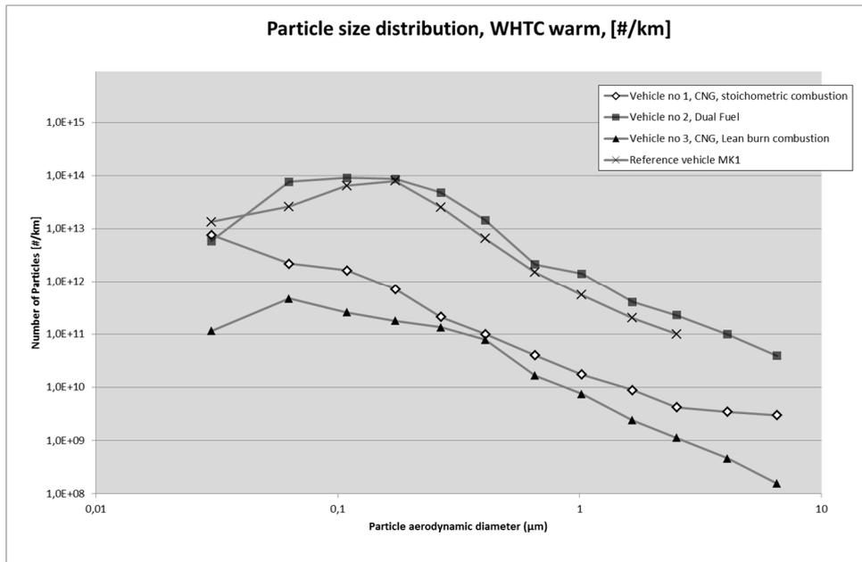
Figur B. Partikelstorleksfördelning för alla fordon vid varmprov
