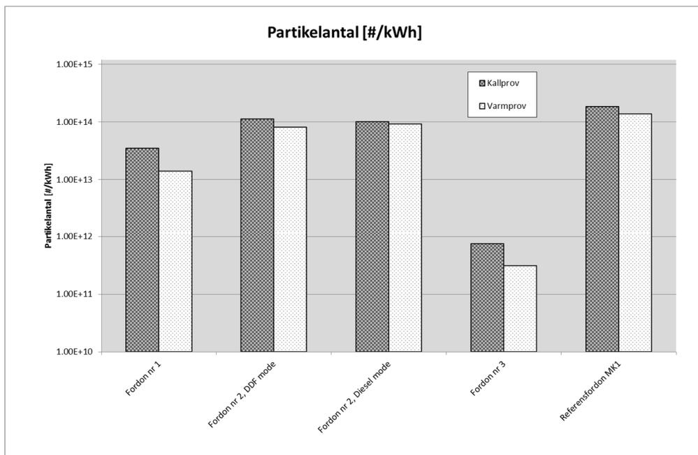
Figur C. Partikelantal för alla provade fordon
