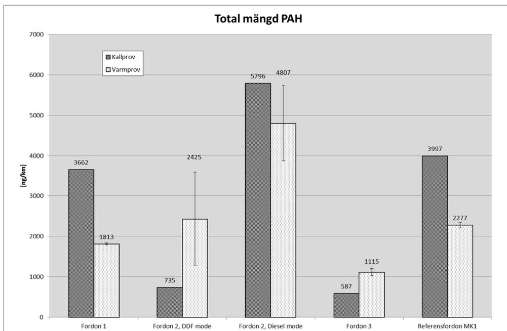
Figur D. Total mängd PAH, alla fordon, varma och kalla prov
