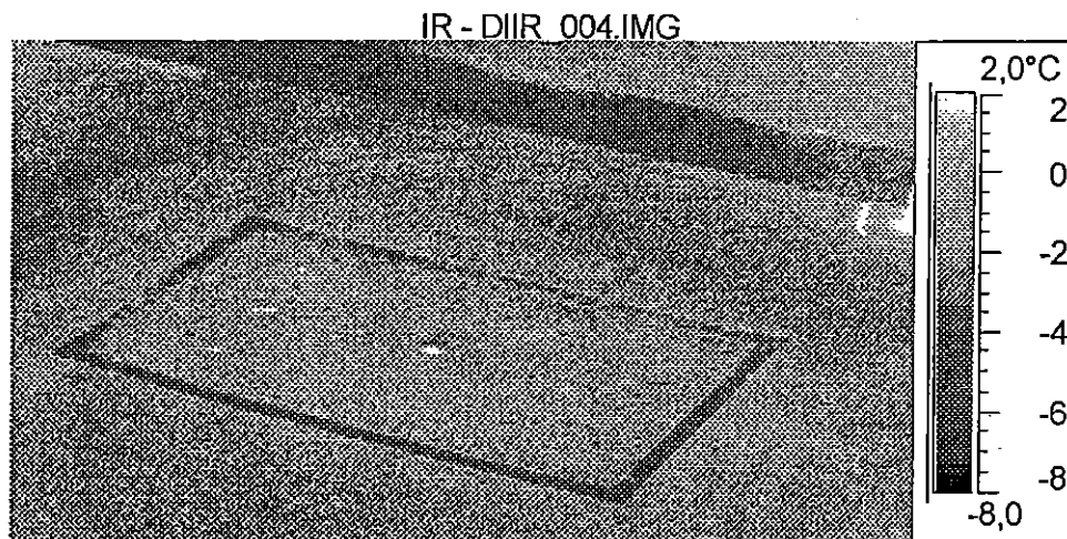
Figur 4. Flygvärmebild med avvikande strålningstemperatur och temperaturmönster, ljusa punkter som indikerar läckage av metangas från markförlagd ledning, bekräftat i fält. Flyghöjd 30 m (90 ft), gstryck 0,5 Bar.
