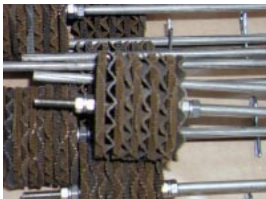
Figur 4.1 TWC nät före installation.
