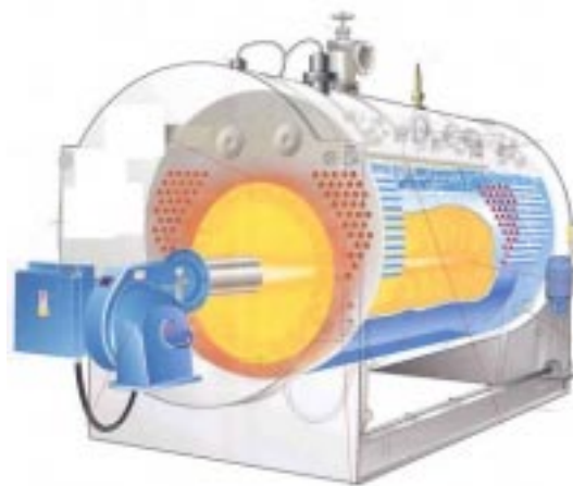
Figur 3.1 Principskiss för en säckeldad panna.
