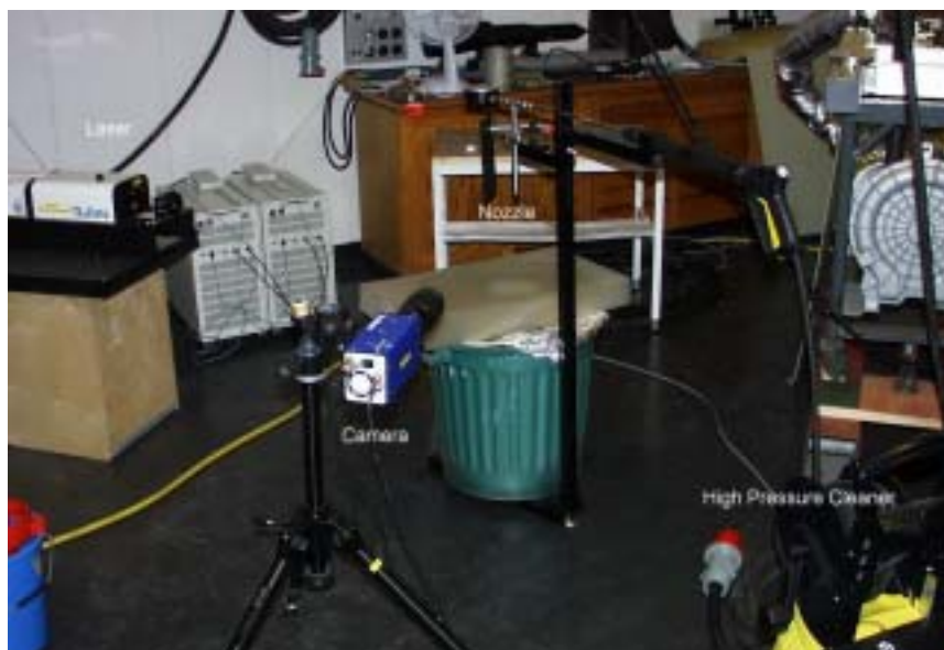
Figur 6: Experimentuppställning för undersökning av sprayer.
