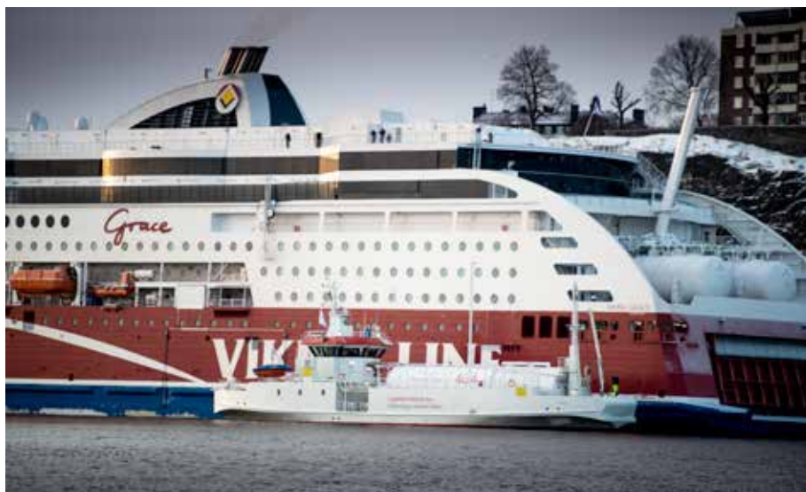
AGA:s LNG-bunkerfartyg Seagas och M/S Viking Grace i Stadsgården, Stockholm. Genom att bunkringen sker på sjösidan kan av- och pålastning ostört ske på landsidan. Bild: Karl Gabor/AGA Gas
