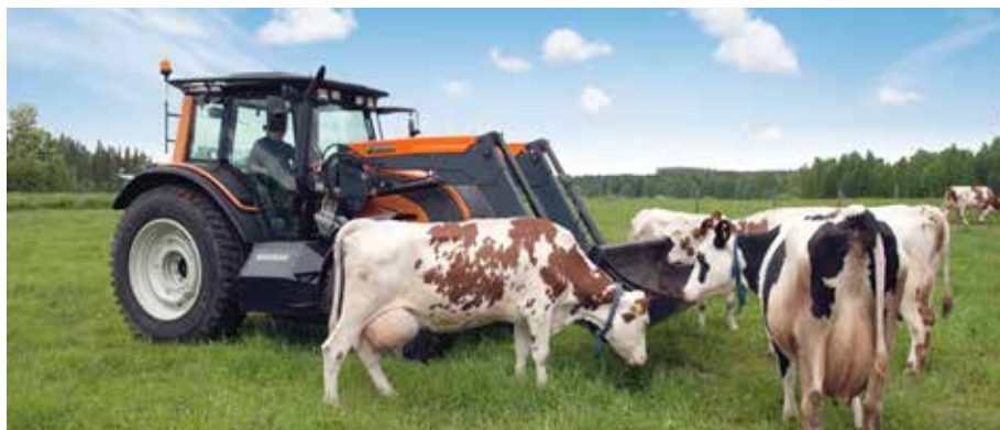
Valtras gasdrivna traktor N101 lanserades 2010. Gastankarna är placerade mellan hjulparen, på ömse sidor om hytten. Efter provkörningar ute hos kund valde Valtra 2012 att starta en begränsad serieproduktion. Typiska användare är lantbrukare med dagligt året-runt-behov av traktor för olika arbeten, och kommuner, till exempel trädgårds- och parkservice. Bild: Valtra
